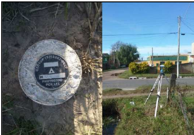
Figura 1 – RN implantado no passeio
